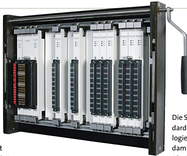
Bild 3: DUT-Interface für Leon-Abex-basierend auf Virginia-Panel-Steckkontakten
